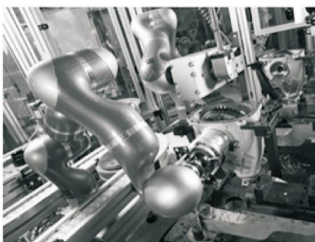
图5 轻量化机器臂用于装配过程的实例
