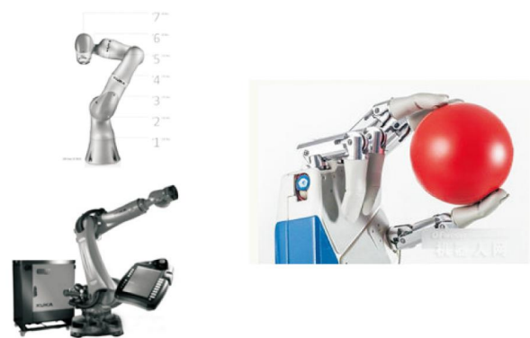
图1：轻量化机械臂和传统工业机器人实物对比
